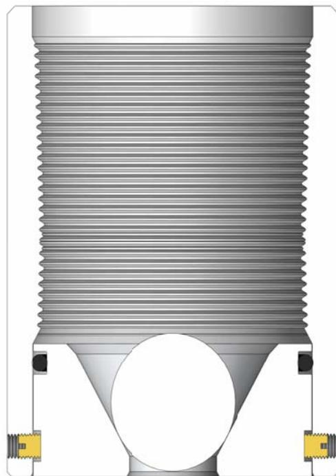
La bomba de enchufe es un tapon de tuberia temporal. Permite que la tuberia a ser presionados para configurar un dispositivo como un empaquetador. Despues de que la presion requerida ha sido alcanzada, los tornillos de cobre, expulsando el nucleo hacia abajo de la tuberia. Diametro completo se realiza una vez que se ha producido el corte.
